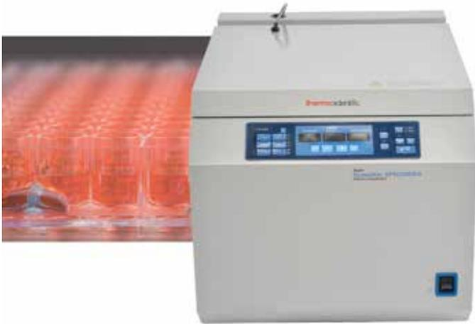
Der Thermo Scientific™ Savant™ SpeedVac™ SPD300DDA Vakuumkonzentrator ist ein Vakuumkonzentrator mit hoher Kapazität und modularem Design, ideal zum Verdampfen von aggressiven organischen Lösemitteln, starke Säuren und Basen und Lösungsmittel für die kombinatorische Chemie. Die SPD300DDA kann größere Mengen von Proben gleichzeitig trocknen und passt sehr gut in die Probenvorbereitung von Hochdurchsatz-Laboren.
