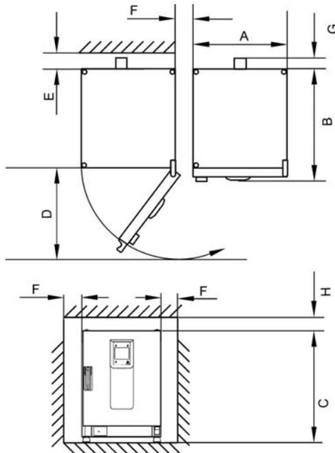
A, B, C et D, voir la notice d'exploitation de l'appareil.
