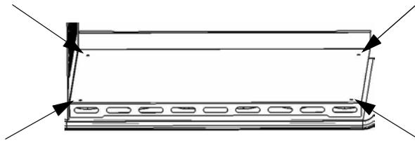
**Figure 5-5** Démontage du panneau inférieur
