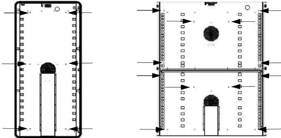
Figure 5-7 Enlèvement du déflecteur arrière IMH 400-S / 750-S
