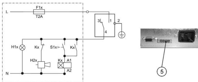
**Figure 5-11 Exemple du raccordement du relais d'alarme**
