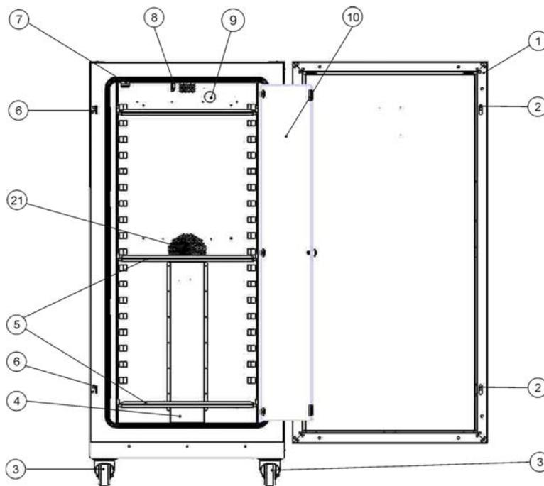
**Figure 4-5 Heratherm IMH 400-S, vue de face**
