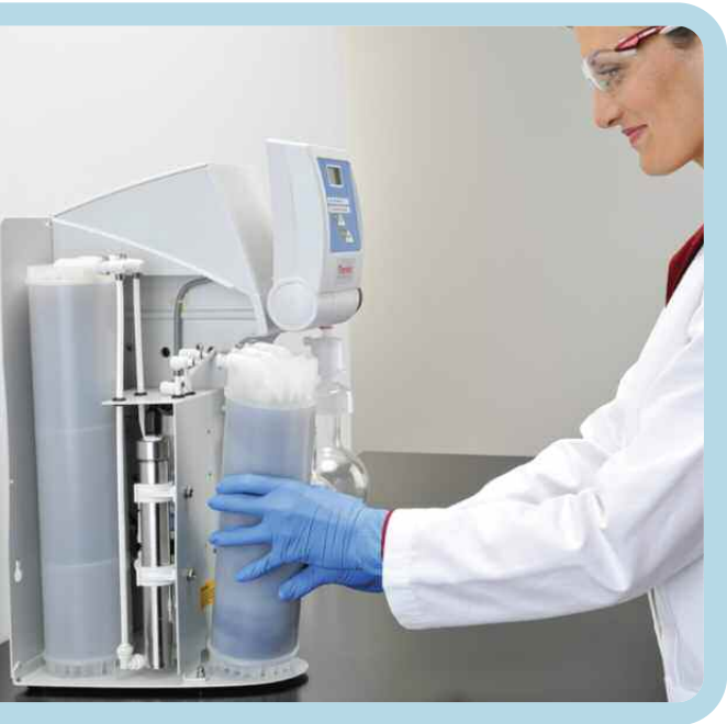
Wirtschaftliches Design Die RO-Membran der Vorbehandlungskartusche ist von der DI-Kartusche getrennt, so dass bei Bedarf nur die jeweilige Kartusche ausgetauscht werden muss.
