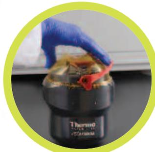
Las tapas de rotores de biocontención **ClickSeal**® ofrecen protección certificada de las muestras con una sola mano
