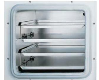
Vakuunkammer mit zwei zusätzlichen Einlagen
