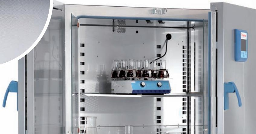
Puerto de acceso para sensor independiente con agitador dentro de la unidad
