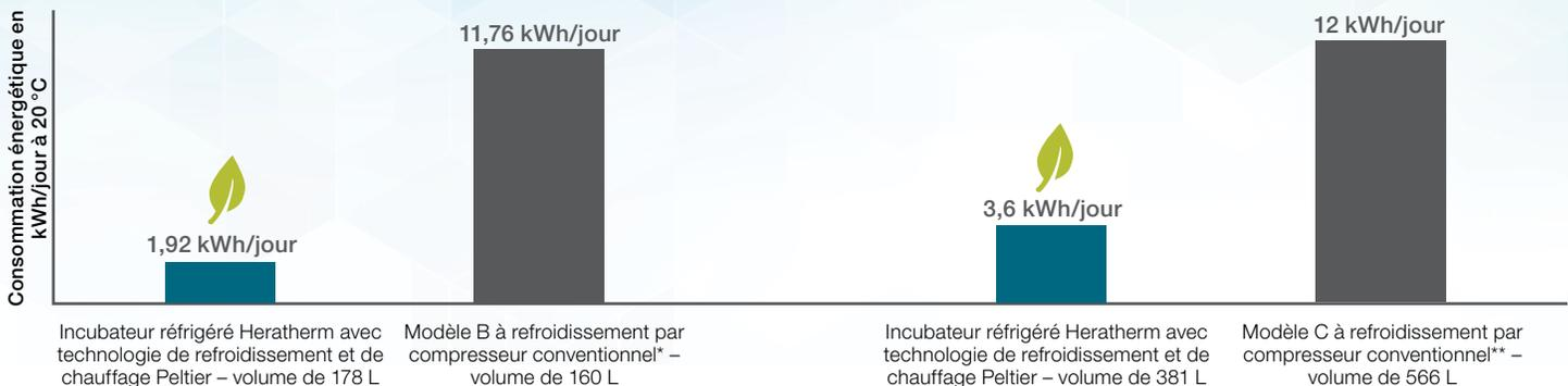
**Défi :** de nombreux incubateurs réfrigérés utilisent des **compresseurs conventionnels**, souvent associés à des éléments de chauffage électrique, pour refroidir et chauffer les appareils. Cette technologie entraîne des désavantages pour l'utilisateur.
