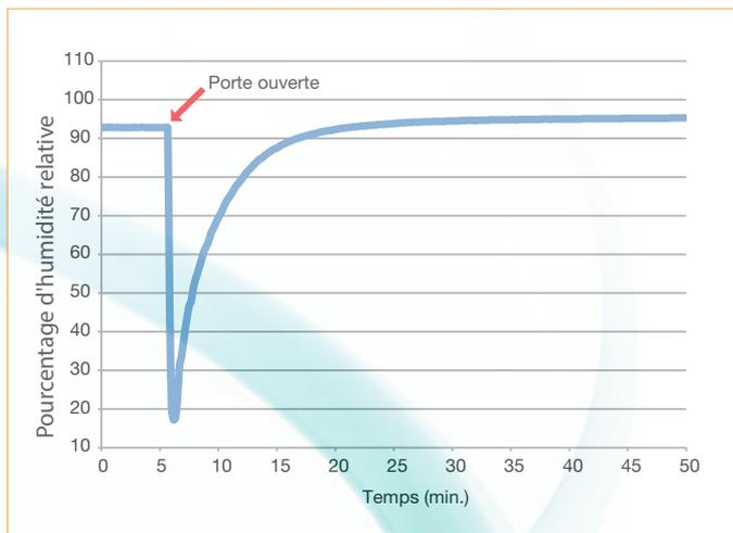
\* Temps de rétablissement de l'humidité calculé à 95 % de la valeur de départ, en fonction des normes de tests internes après une ouverture de porte de 30 secondes.
