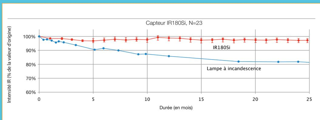
Les capteurs IR traditionnels renferment un bulbe incandescent dont l'intensité lumineuse baisse avec le temps et provoque une dérive du capteur. Le capteur IR180Si élimine ce type de problème. Notre émetteur MEMS à base de silicium est conçu pour maintenir l'intensité lumineuse au fil du temps avec une durée de vie deux fois plus longue que les capteurs IR ordinaires.
