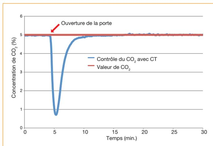
TC180 – Temps de récupération du CO<sub>2</sub> inférieur à 6 minutes après une ouverture de porte de 30 secondes.
