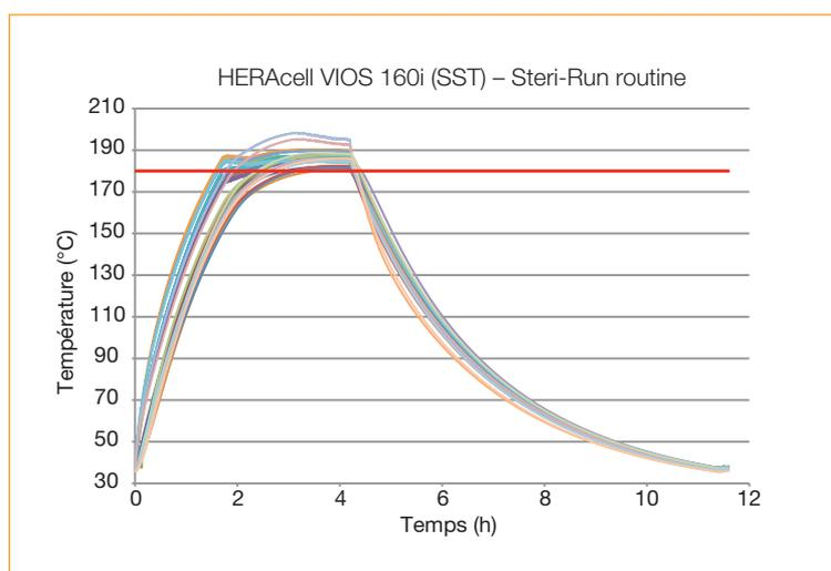
Les pharmacopées américaine et européenne ne recommandent plus de température et de durée pour les procédures de stérilisation. Elles exigent à la place une preuve de la performance. Pour correspondre aux exigences relatives à un niveau de garantie de stérilité de 12 log SAL, une réduction de 6 log des endospores d'indicateur biologique doit être démontrée en moitié moins de temps.
