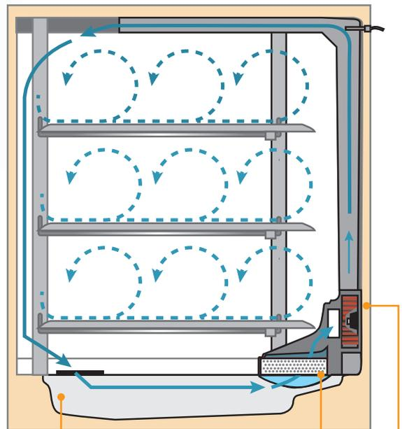
L'air entrant circule d'abord dans un réservoir d'eau chauffé en direct, permettant une récupération de l'humidité 50% plus rapide qu'avec un bac à eau standard.\*\*
