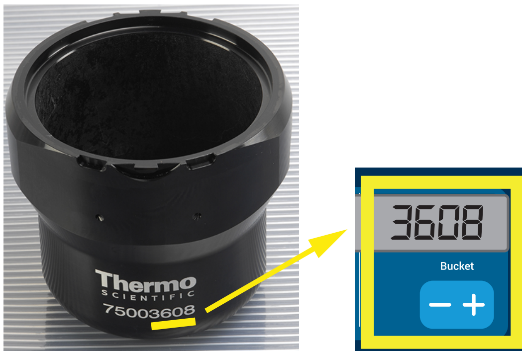
Kuva 4–8: Roottorin kannatinkupin oikean koodin määrittäminen
