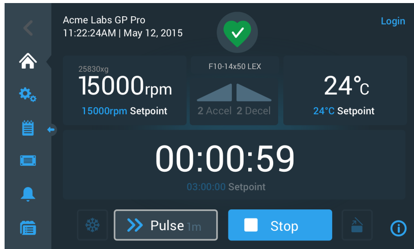
Kuva 3-25: Pulssi-tila: Sentrifugi käy yhden minuutin ajan
