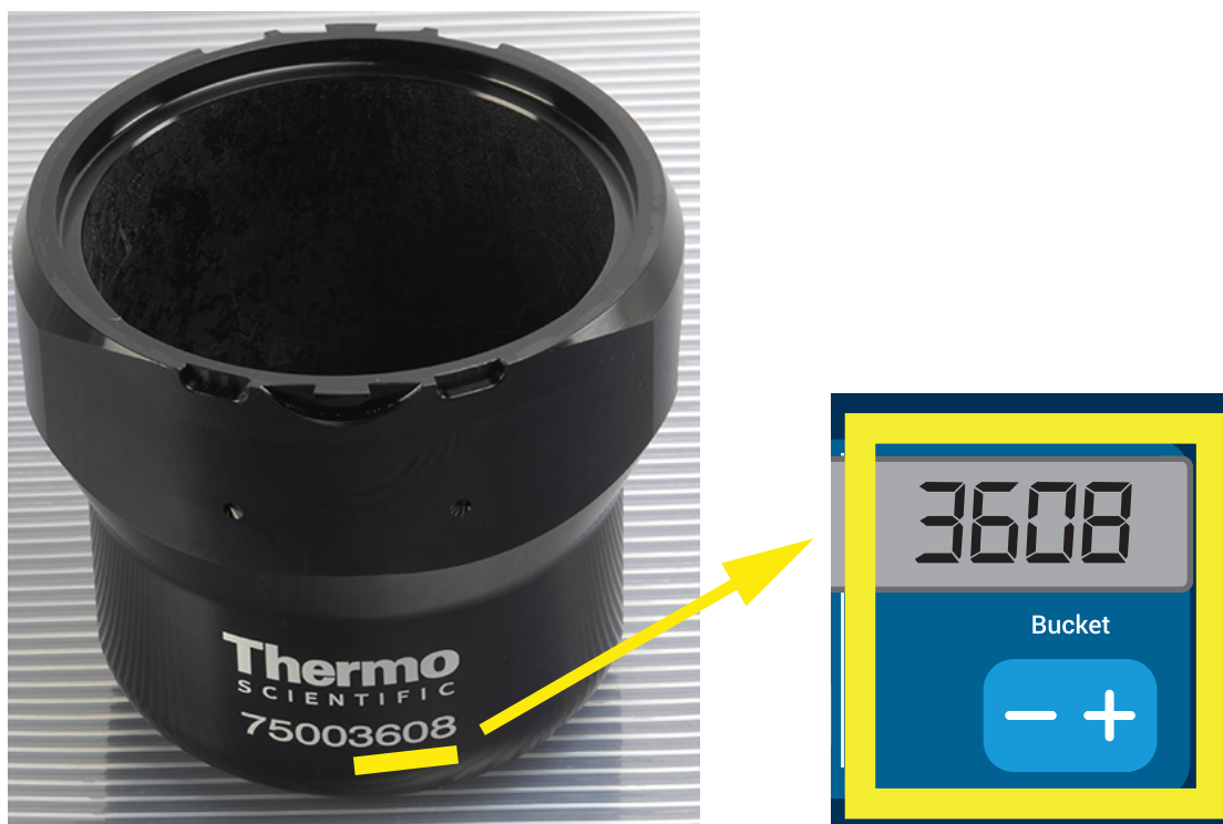
Obr. 2–15: Nastavení správného kódu závěsu pro rotor
