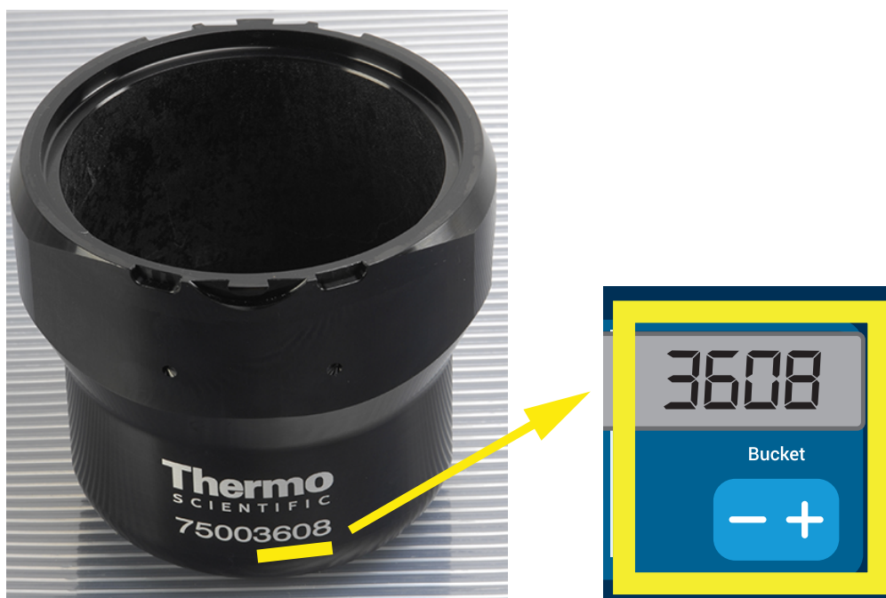
Figure 4-8 : Réglage du bon code de nacelle pour le rotor
