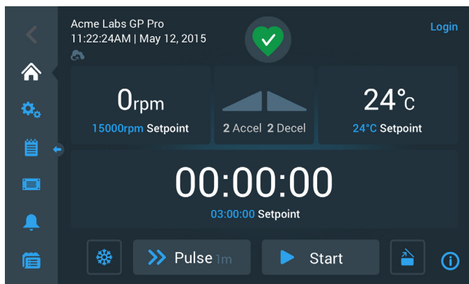
Figure 3-3 : Écran tactile d'une centrifugeuse réfrigérée
