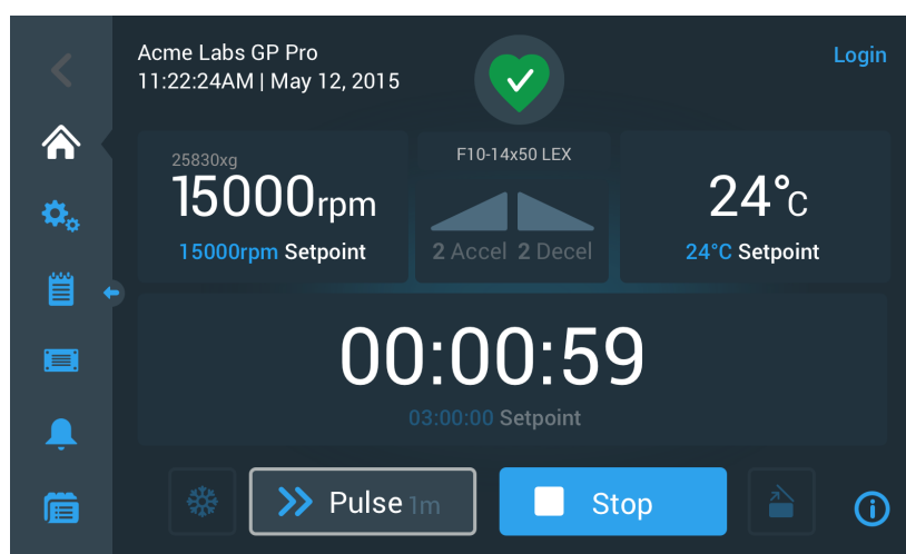
Figure 3-25 : Mode impulsion : centrifugeuse fonctionnant depuis 1 minute
