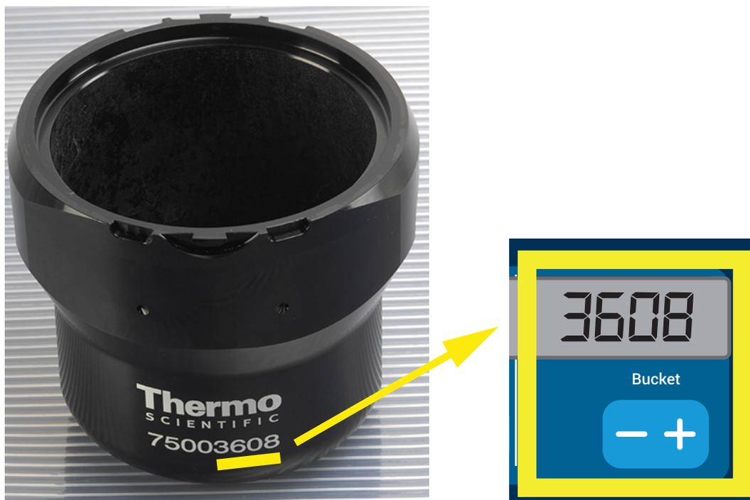
Abbildung 4–8: Korrekten Bechercode für den Rotor einstellen
