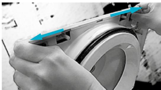
**CUIDADO** Durante a montagem da tampa de escoamento deve-se tomar cuidado para que o bocal do meio da tampa seja colocado na abertura da tampa de escoamento. Insira corretamente a tampa de escoamento.
