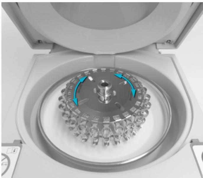
**CUIDADO** Se o rotor for instalado incorretamente, o receptor do rotor pode soltar-se da bacia da centrífuga e oscilar exageradamente.
