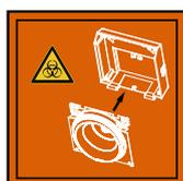
Esse símbolo indica a necessidade de colocação da tampa de escoamento na tampa da centrífuga de lavagem de células antes do início da centrífuga de lavagem de células CW3. Se isso não for feito e forem utilizadas amostras contaminadas, existe o potencial de perigo biológico.
