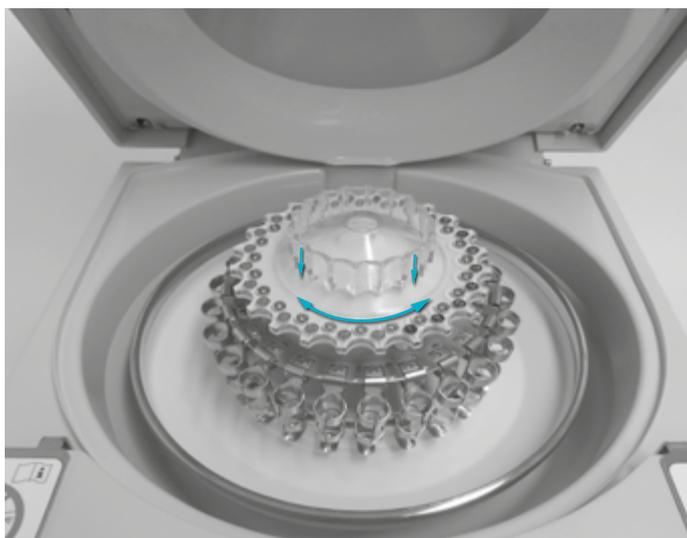
Verifique se os pinos do lado inferior do distribuidor entram nas aberturas do lado superior do rotor.
