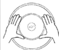
3. Pressione a bacia da centrífuga completamente para baixo, até a base do tambor do decantador ficar alinhada com a base da bacia centrífuga. Com os dedos, verifique se os cantos se fecham bem.
