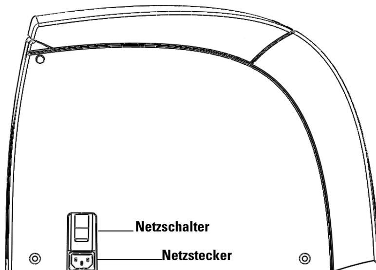
Abbildung 2-2. Netzanschlüsse
