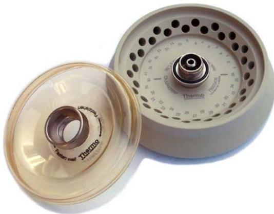
Para fechar o rotor, posicione a tampa do rotor no centro do rotor. Para fixar a tampa do rotor gire a porca da tampa no sentido dos ponteiros do relógio.
