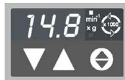
Apertando as teclas **brevemente**, o número de rotações é aumentado ou reduzido passo a passo (em 100  $\text{min}^{-1}$ ). Esta opção deve ser usada para alterações pequenas ou o ajuste exato.
