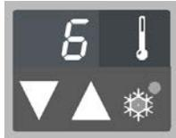
si può ora aumentare o diminuire la temperatura con incrementi di 1° premendo **brevemente** il tasto di impostazione.
