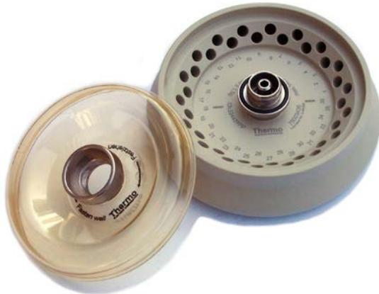
Per chiudere il rotore, posizionate il coperchio centralmente sul rotore e girate in senso orario il dado che va così a bloccare il coperchio stesso.
